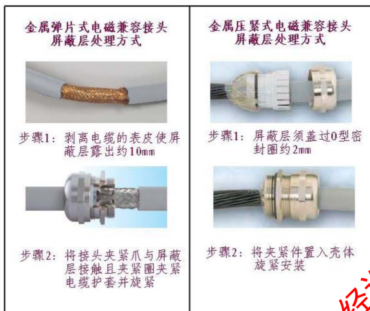
图 6-2 电磁接头屏蔽层处理方式
