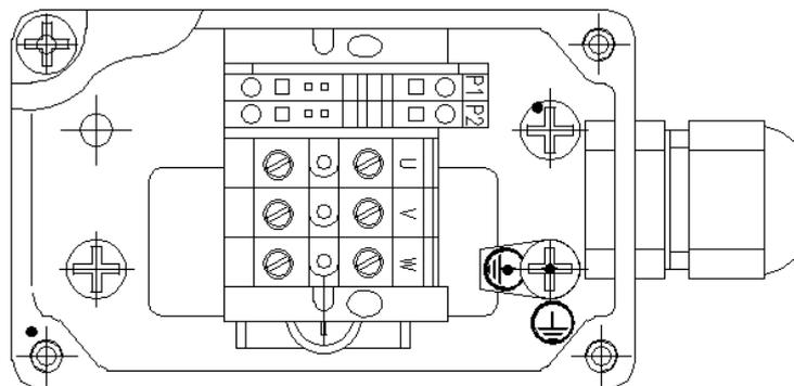
图 6-1 接地装置
