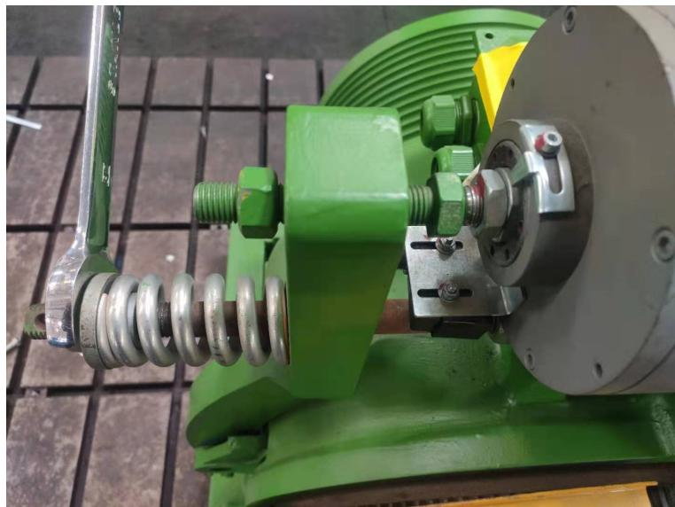
2. 用十字螺丝刀将固定微动开关支架的两件螺钉 M4 松开，拆下微动开关支架（包括微动开关），拆下另一侧的微动开关。
