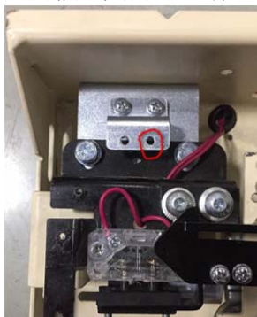
厅门强迫关门重锤钢丝绳与中间门锁连接示意图画圈处螺纹
